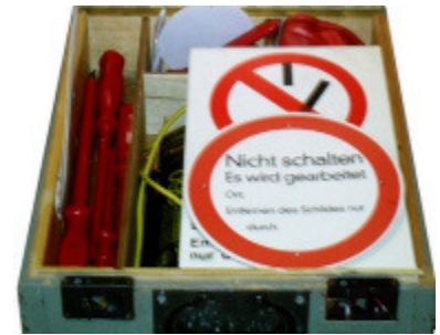
Abbildung 9: Beispiel Feuerwehrelektrowerkzeugkasten (alte Ausführung)
