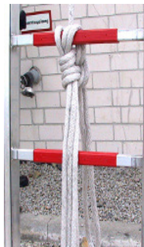
Abbildung 11: Anschlagen Zugseile an die Sprossen der Schiebleiter
