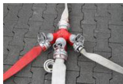
Abbildung 16: Anschluss der Druckschläuche an einem Verteiler
