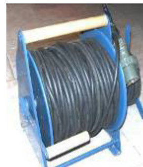
Abbildung 7: Leitungstrommel nach DIN 14680
